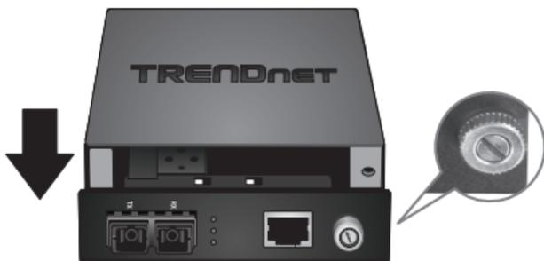
3. Faites glisser le convertisseur fibre dans un logement libre et serrez la vis à ailettes.
