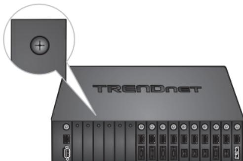
2. Enlevez le TFC-1000MSC en dévissant la vis à ailettes et enlevez l'appareil du boîtier métallique.
