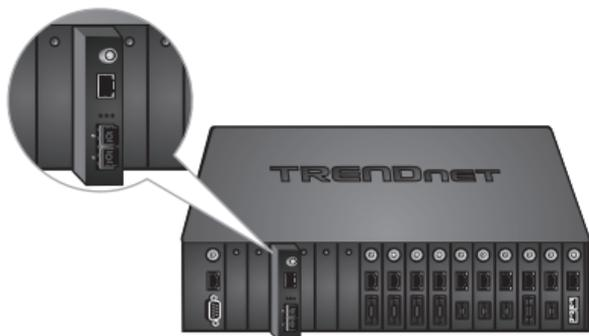
4. Connectez un câble réseau entre le port Gigabit du convertisseur fibre et un port Gigabit de votre switch. Vous pouvez dès lors vous connecter à un autre convertisseur fibre ou à tout autre périphérique disposant d'un port Gigabit et d'un port fibre.
