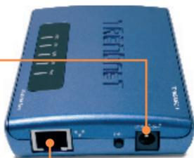
3. Conecte um cabo de rede RJ-45 de um Switch/Roteador à porta **LAN** do Servidor de Impressão.
