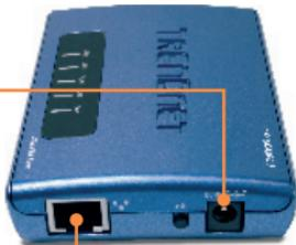
3. Branchez un câble réseau RJ-45 entre le Switch/Routeur et le port **LAN** du serveur d'impression.
