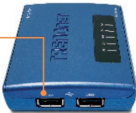
4. Connectez l'imprimante USB au port **USB** du serveur d'impression
