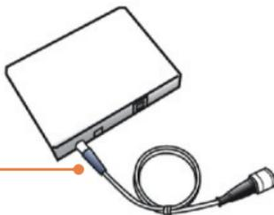
3. Conecte a ponta encapada preta(N) do cabo jumper ao TEW-ASAK.
