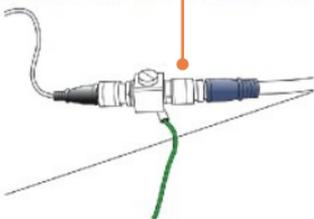
**5.** Passe o cabo da antena pela base de montagem.
