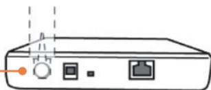
2. Conecte a ponta encapada azul (SMA Reverso) do cabo jumper (fornecido com o TEW-ASAK) ao seu Ponto de Acesso ou Roteador Wireless.
