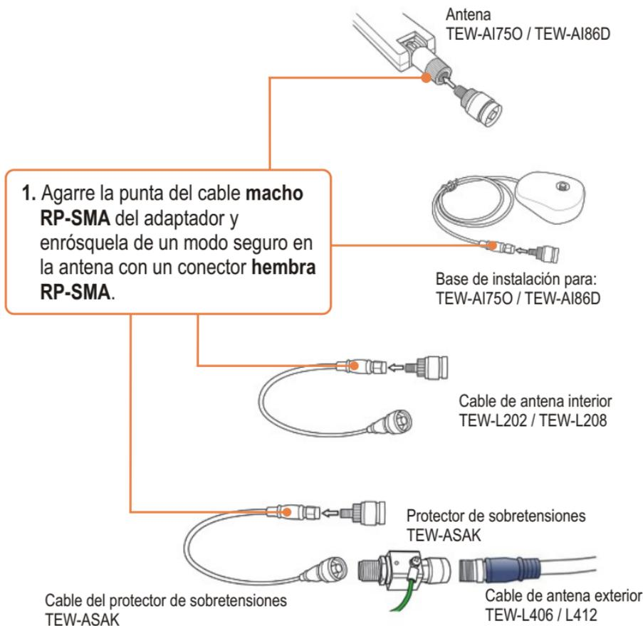
Nota: Para aplicaciones exteriores, el protector de sobretensiones TEW-ASAK se debe de usar con cables de antena exteriores como el TEW-L406 o TEW-L412.
