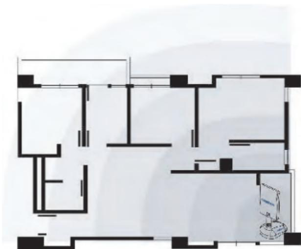
Антенны TEW-AI86D также можно установить в боковой части / на краю зоны уверенного приема при передаче на дальнее расстояние через зал / коридор.
