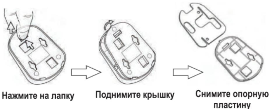
Сняв нижнюю крышку с опорной поверхности, снимите металлическую опорную пластину с потолочных зажимов, открыв доступ к отверстиям под шурупы.
