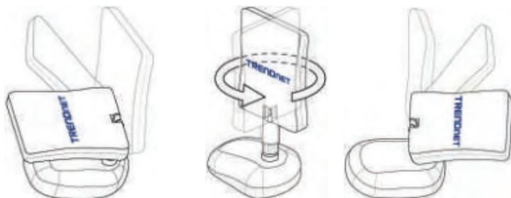
**⚠ Внимание:** Антенна наклоняется под углом от  $0^\circ$  до  $180^\circ$  и вращается на  $360^\circ$ . Внутренний антенный провод закреплен, поэтому не следует поворачивать антенну на более чем  $360^\circ$ .
