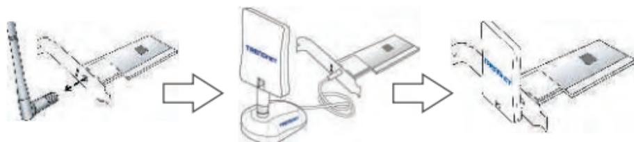
**⚠️ Рекомендация:** В связи с двунаправленностью WiFi-устройств (прием/передача) рекомендуется также установить в качестве клиента внешние антенны на базовой станции точки доступа.
