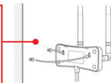
4. Posicione as antenas para que fiquem perpendiculares ao chão.
