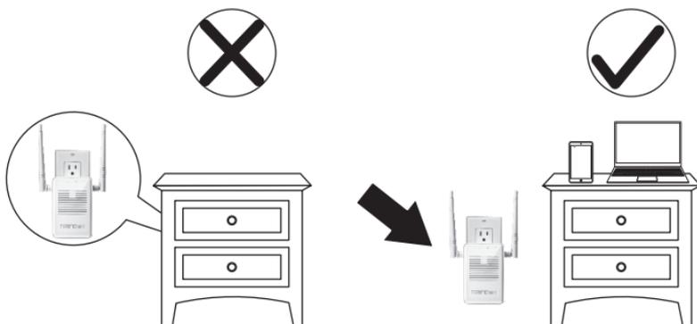
**Nota:** El esquema de abajo indicará la intensidad de la conexión wireless entre el router y el TEW-822DRE.
