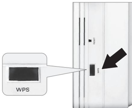
4. Drücken Sie innerhalb von zwei Minuten die WPS Taste an Ihrem Wi-Fi Router und halten Sie diese fünf Sekunden lang gedrückt, um die WPS-Kopplung herzustellen.
