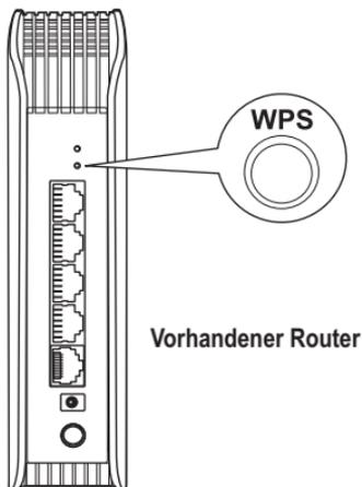
5. Die WPS-Taste hört auf zu blinken, wenn der WPS-Prozess abgeschlossen ist. Stellen Sie sicher, dass die Wireless-LED aufleuchtet.
