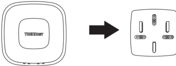
2. Platzieren Sie die Befestigungsplatte an der Wand oder Decke, an der das Gerät angebracht werden soll und markieren Sie die Position der Löcher für die Schrauben. Stellen Sie sicher, dass das Gerät genug Platz hat, um auf die Befestigungsplatte geschoben oder entfernt zu werden. Wenn Sie für die Installation kein PoE verwenden, stellen Sie bitte sicher, dass Sie die Befestigungsplatte mit einer Steckdose verbinden können.
