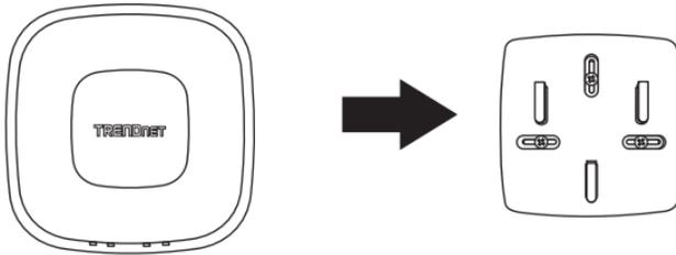
2. Positionnez la plaque de fixation sur le mur ou le plafond où l'appareil se trouvera et marquez l'emplacement des trous pour les vis. Assurez-vous que l'appareil dispose de suffisamment d'espace pour coulisser dans la plaque de fixation et pour en sortir. S'il ne s'agit pas d'une installation PoE, assurez-vous que l'emplacement de la fixation se trouve à proximité d'une prise de courant.
