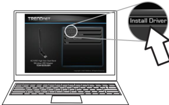
4. Folgen Sie den Anweisungen des InstallShield Assistenten und starten Sie den Computer neu, nachdem die Installation abgeschlossen ist. Nachdem der Computer neu gestartet wurde, stecken Sie den TEW-805UBH in einen beliebigen USB-Port an Ihrem PC ein.
