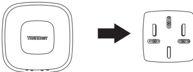
2. Platzieren Sie die Befestigungsplatte an der Wand oder Decke, an der das Gerät angebracht werden soll und markieren Sie die Position der Löcher für die Schrauben. Stellen Sie sicher, dass das Gerät genug Platz hat, um auf die Befestigungsplatte geschoben oder entfernt zu werden. Wenn Sie für die Installation kein PoE verwenden, stellen Sie bitte sicher, dass Sie die Befestigungsplatte mit einer Steckdose verbinden können.
