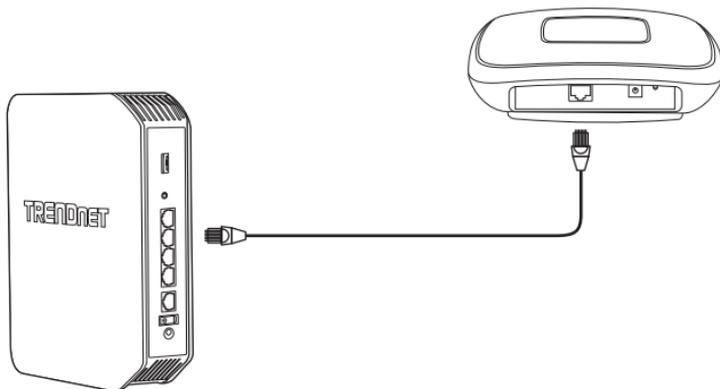
2. Wenn Sie Ihren TEW-755AP mit einem PoE Switch verbinden, fährt das Gerät automatisch hoch. Wenn Sie das Gerät mit einem Computer oder einem nicht-PoE Switch verbinden, müssen Sie den mitgelieferten Netzadapter verwenden.
