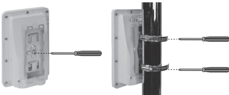
4. Ajuste la orientación de la antena según sea necesario.
