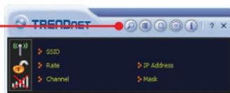
3. Selecione o SSID e então clique a conexão. O SSID é o nome da rede wireless (exemplo. Roteador wireless ou Ponto de Acesso).
