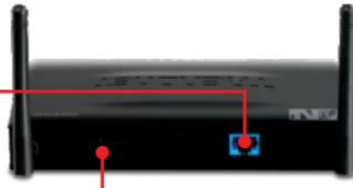
2. Verbinden Sie das Netzteil mit dem TEW-670AP und stecken Sie es in eine Steckdose.
