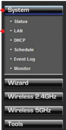
12. Configurez les paramètres LAN afin qu'ils correspondent à vos paramètres réseau et cliquez sur Apply (Appliquer).
