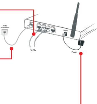
2. Branchez une extrémité du câble RJ-11 au port ADSL du TEW-657BRM. Branchez l'autre extrémité à la prise du téléphone.
