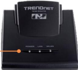
6. Vajutage TEW-654TR küljes olevat WPS nuppu 5 sekundit ja vabastage siis. WLAN LED tuli peab hakkama kollaselt plinkima.
