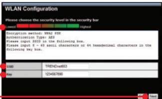
7. Introduzca el **SSID** deseado y la **clave**. Luego, haga clic en **Next** (Siguiiente). el SSID predeterminado es TRENDnet653.
