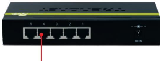
3. Conecte un cable CAT-5 del comutador al puerto DATA IN del TPE-111GI.
