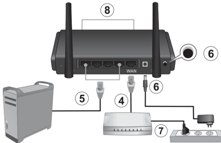
6. Verbinden Sie das Netzteil mit dem TEW-652BRU und stecken Sie es in eine Steckdose. Stellen Sie den Einschalter auf "Ein".
