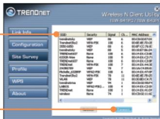
6. Если в вашей беспроводной сети используется шифрование, будут автоматически выбраны необходимые типы **Аутентификации (Authentication)** и **Шифрования (Encryption)**. Введите ключ шифрования и нажмите **Apply**.
