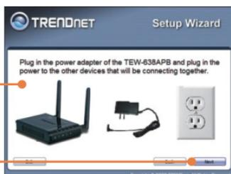
7. Подключите силовой адаптер к точке доступа и сетевой розетке. Затем нажмите на кнопку **Далее**.
