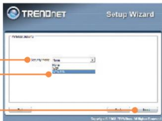
16. Wählen Sie den gewünschten **WPA-Modus** aus, geben Sie einen vorinstallierten Schlüssel ein, lassen Sie **Cipher Type** (Verschlüsselungsart) auf **TKIP and AES** stehen und klicken Sie dann auf **Next** (Weiter). Für WPA-PSK und WPA2-PSK muss der vorinstallierte Schlüssel 8 bis 63 ASCII- bzw. 64 HEX-Zeichen lang sein. Notieren Sie sich den vorinstallierten Schlüssel.
