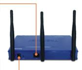
2. Conecte o Adaptador de Energia AC ao Ponto de Acesso e em seguida a uma tomada.
