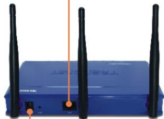
2. Verbinden Sie den Stromadapter mit dem Access Point und stecken Sie ihn in eine Steckdose.
