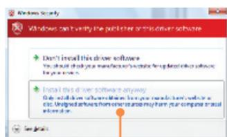
5. Cliquez sur **Install this driver software anyway** (Installer le pilote de ce logiciel de toute façon).
