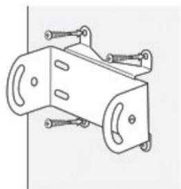
**6.** Inserte el soporte de fijación en el soporte de sujeción a pared y fíjelo con las arandelas y tornillos suministrados.
