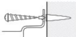
5. Utilice los tornillos para madera suministrados para fijar el soporte de sujeción de la unidad exterior/rótula a la pared con las clavijas de la pieza de sujeción.
