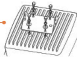
2. Utilice el soporte de sujeción a pared como molde y marque la correcta posición del tornillo/pieza de sujeción en la pared.
