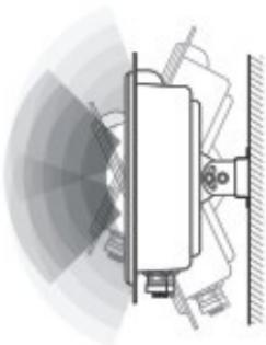
**7.** Ajuste la orientación de la antena según sea necesario.
