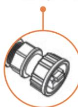
10. Conecte el anillo de la abrazadera y la tuerca de fijación al puerto PoE de la parte posterior del TEW-455APBO.
