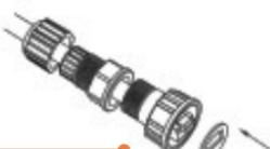
9. Introduzca la junta en el extremo frontal del conector. Luego, vuelva a colocar la tuerca de fijación.
