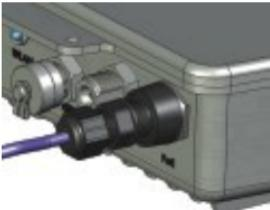
**11.** Conecte el otro extremo del cable Ethernet al puerto **LAN + DC** del adaptador PoE.
