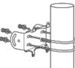
**3.** Fije el soporte de sujeción al soporte de sujeción de la torre usando las tuercas y arandelas suministradas.
