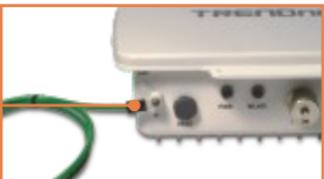
3. Conecte el cable verde del conductor a tierra a un objeto de la toma a tierra. Ej. Elemento conductor, sistema eléctrico de toma a tierra, estructura del edificio.
