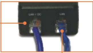
**12.** Conecte la otra punta del cable Ethernet al puerto **LAN**.
