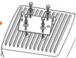
**2.** Задвиньте вокруг опоры U-образные зажимы из комплекта. Поместите деталь крепления на опоре на нужной высоте и в нужном положении.
