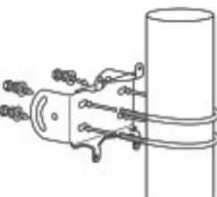
**3.** Закрепите этот держатель на детали крепления на опоре с помощью гаек и шайб из комплекта.
