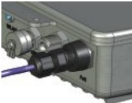
11. Присоедините противоположный конец кабеля Ethernet к порту **LAN + DC** на адаптере Power over Ethernet.
