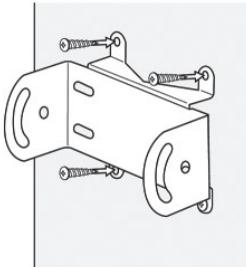
**6.** Вставьте кронштейн в настенный кронштейн и закрепите его шайбами с болтами из комплекта.
