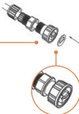
**10.** Присоедините зажимное кольцо и установочную гайку к порту PoE на задней стороне устройства TEW-455APBO.
