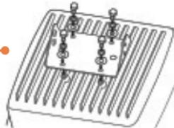
2. Воспользуйтесь в качестве шаблона консолью и разметьте место на стене для правильного положения шурупов / деталей крепления.
