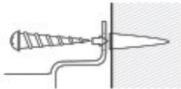
5. Шурупами из комплекта приверните наружное устройство/качающуюся опору к дюбелям в стене.
