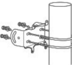
3. Fixez le support de fixation sur celui de la perche à l'aide des écrous et des rondelles fournis.
