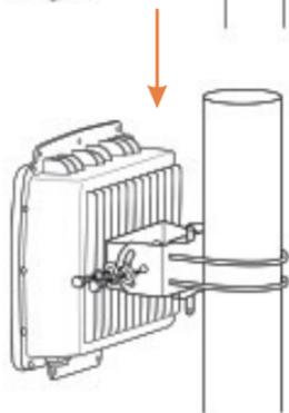
4. Adaptez l'orientation de l'antenne au besoin.
