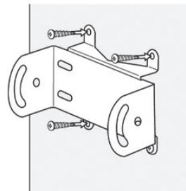
6. Insérez le support de fixation à celui du mur et fixez le tout à l'aide des rondelles et des vis fournies.
