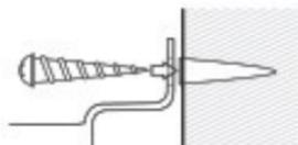
5. Utilisez les vis en bois fournies pour visser le support de fixation/pivotement extérieur aux fixations du mur.
