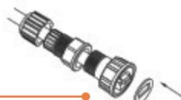
9. Insérez le joint sur l'embout avant du connecteur. Remplacez ensuite l'écrou de la vis au dos.
