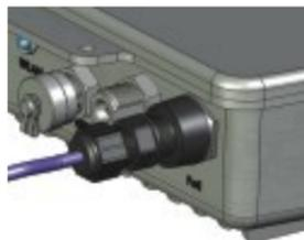
11. Connectez l'autre extrémité du câble Ethernet au port **LAN + DC** de l'adaptateur Power over Ethernet.
