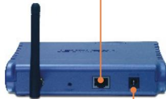
2. Conecte el adaptador de alimentación AC al Punto de Acceso y luego a una toma de corriente.
