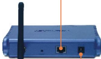
2. Conecte o Adaptador de Tensão Externo ao Ponto de Acesso e em seguida a uma tomada.
