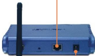
2. Verbinden Sie den Stromadapter mit dem Access Point und stecken Sie ihn in eine Steckdose.
