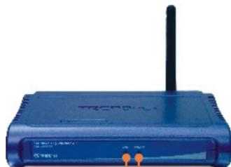
3. Kontrollieren Sie, dass auf der Vorderseite die folgenden Anzeigen leuchten: **LAN** und **WLAN**.
