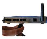
2 - Connectez le câble RJ 45 au routeur à l'emplacement marqué LAN 1 et à la prise Ethernet de la carte réseau de votre ordinateur (prise de même forme que celle du routeur).
