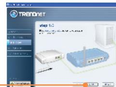
8. Izraujiet esošā Ethernet kabeļi no sava DSL vai kabeļmodema un iespraudiet to TEW-432BRP dzeltenajā portā numur 1. Tad uzklikšķiniet uz **Next** pogas
