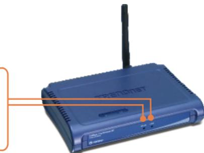
3. Kontrollieren Sie, dass auf der Vorderseite die folgenden Anzeigen leuchten: **WLAN** und **LAN**.
