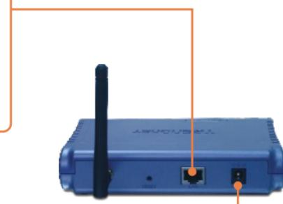
2. Verbinden Sie den Stromadapter mit dem Access Point und stecken Sie ihn in eine Steckdose.
