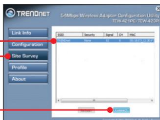
3. Si le cryptage est activé sur votre point d'accès, sélectionnez l'authentification et le cryptage, saisissez la clé de cryptage et cliquez sur **Apply** (Appliquer).
