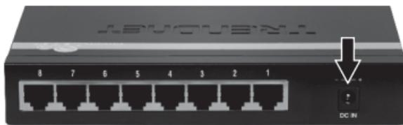
2. Conecte um cabo de rede RJ-45 CAT-5e ou CAT-6 do computador a uma porta Ethernet disponível no TEG-S80g.
