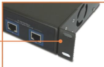
4. Posicione cuidadosamente o switch no rack. Alinhe o suporte aos furos de parafusos no rack, então use os parafusos fornecidos para fixar o switch.
