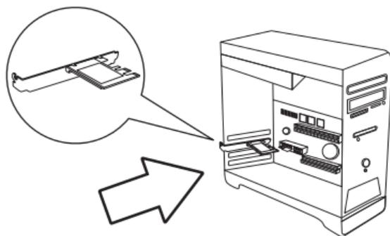
6. Tras fijar el adaptador con los tornillos necesarios, cierre la caja de la computadora y enciéndala. Se detectará automáticamente el adaptador.
