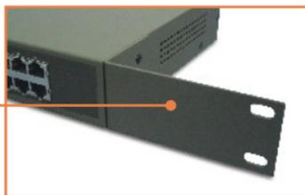
2. Аккуратно распо-ложите шасси на стойке. Выров-няйте кронштейн относительно вин-товых отверстий на стойке, затем прикрепите шасси винтами из комплекта к приборной стойке.
