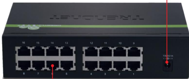
2. Conectați un cablu de rețea CAT-5, CAT-5e sau CAT-6 RJ-45 de la computer la un port liber Ethernet de la TE100-S16Eg
