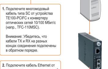
2. Подключите кабель Ethernet от конвертера для оптических сетей к порту Gigabit Ethernet коммутатора (напр.,TEG-424WS).
