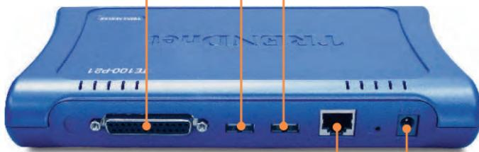
2. Verbinden Sie den LAN-Port über das RJ-45-Kabel mit dem Hub oder Switch Ihres Netzwerks.
