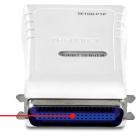
3. Присоедините параллельный принтер к порту **Parallel** сервера печати.
