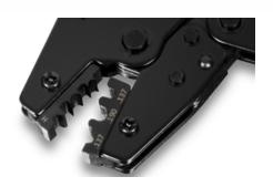
**Engaste de cables de fibra** Concebida para engastar cables SC y ST
