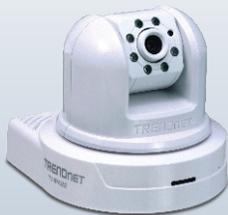
**Drahtloser Internet-Kameraserver für Tag- und Nachtaufnahmen mit Schwenk-/Neigekopf und interaktiver Audiofunktion**
